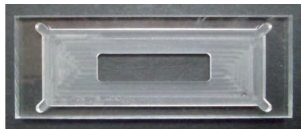
Abbildung 1: Acrylglasplatte für das Blutauftragen auf dem Prüfkörper.
