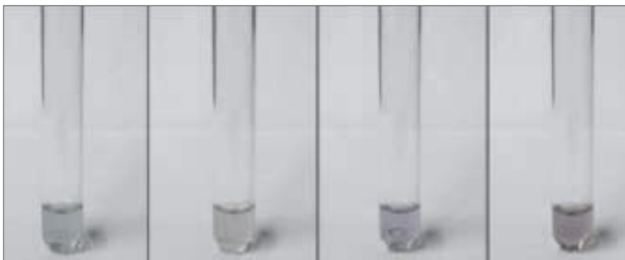
Abb. 6: Färbungsergebnis der BCA-Reaktion (Fa. Pierce) mit Proteinlösungen der Konzentrationen 5µg/ml, 50 µg/ml, 100 µg/ml und 125 µg/ml BSA.
